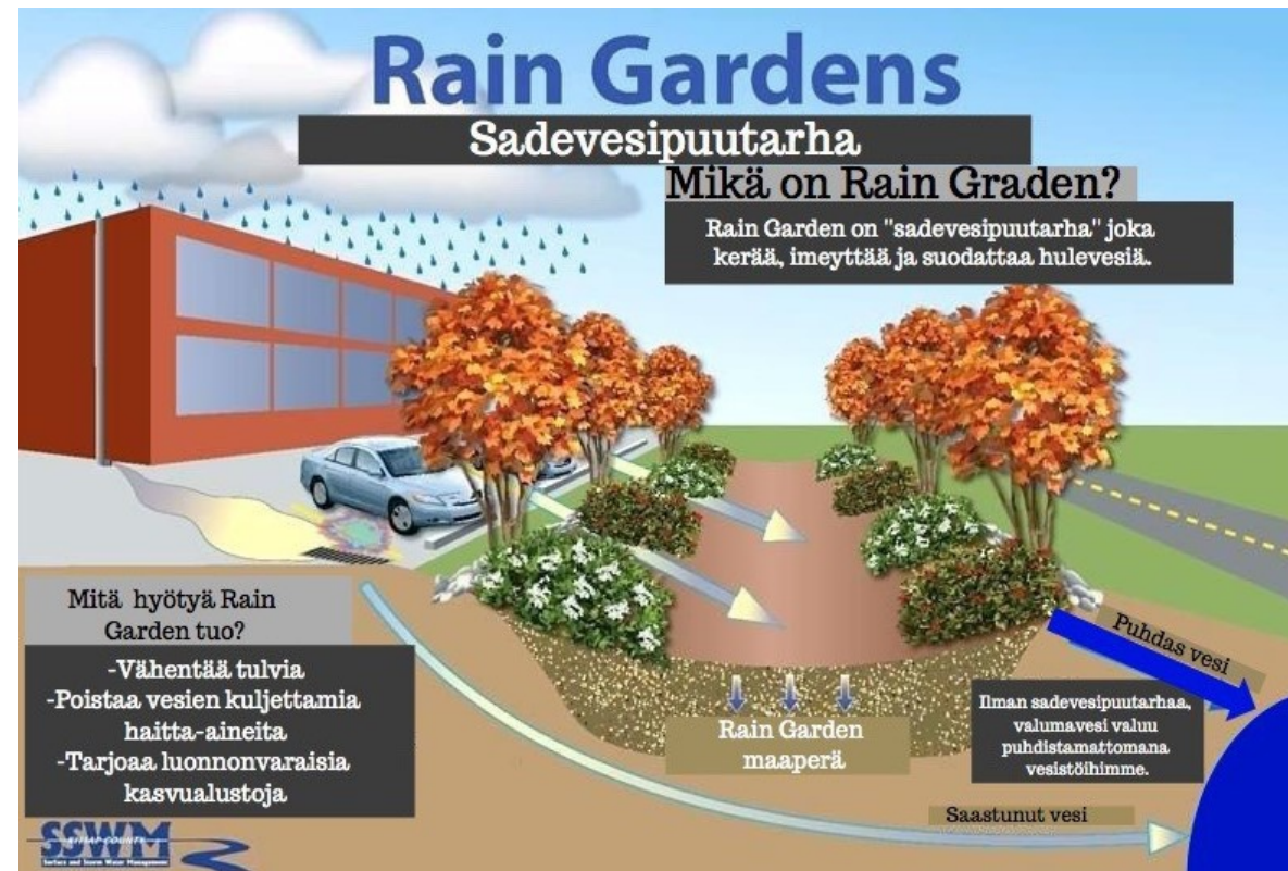
Kuva 9. Sadevesipuutarhan toimintaperiaate (muokattu).
